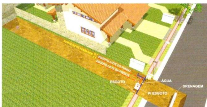
Indicação esquemática de utilização de servidões de passagem para ligação de esgotos e águas pluviais
