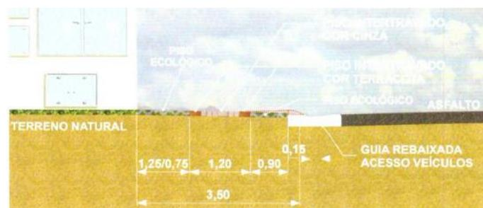
Detalhe ampliado do rebaixamento de guia
