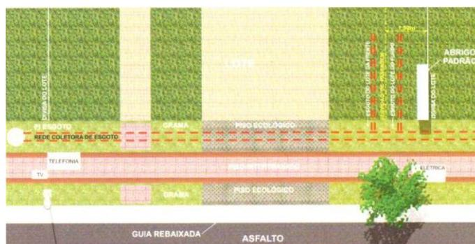
Servidões de passagem para interligação de esgoto
