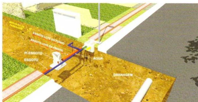
Detalhe ampliado das interligações de esgotos e águas pluviais para lotes com servidão de passagem
