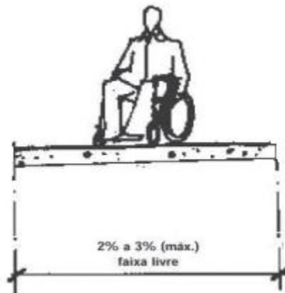
Ilustração sobre a inclinação transversal da calçada
